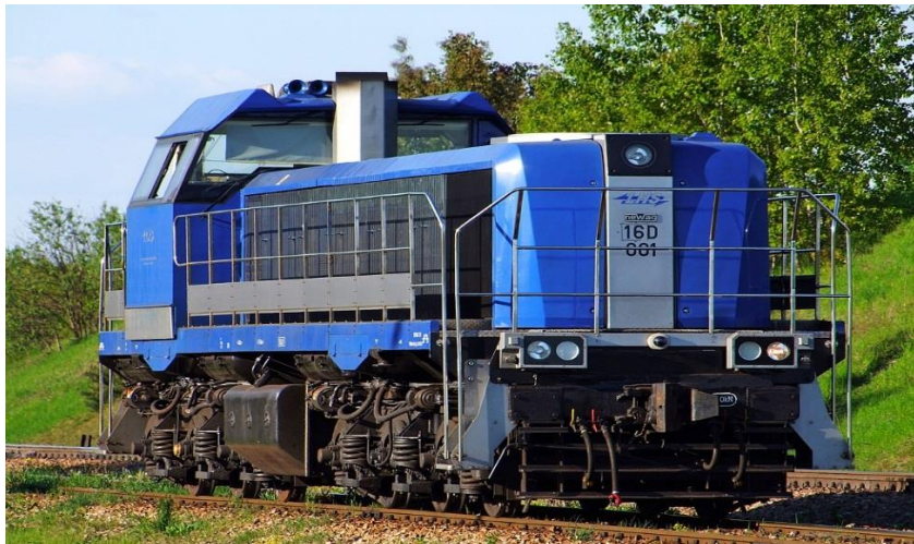
Rys.4 Lokomotywa spalinowa 16D po przeprowadzonej modernizacji lokomotywy SM48
