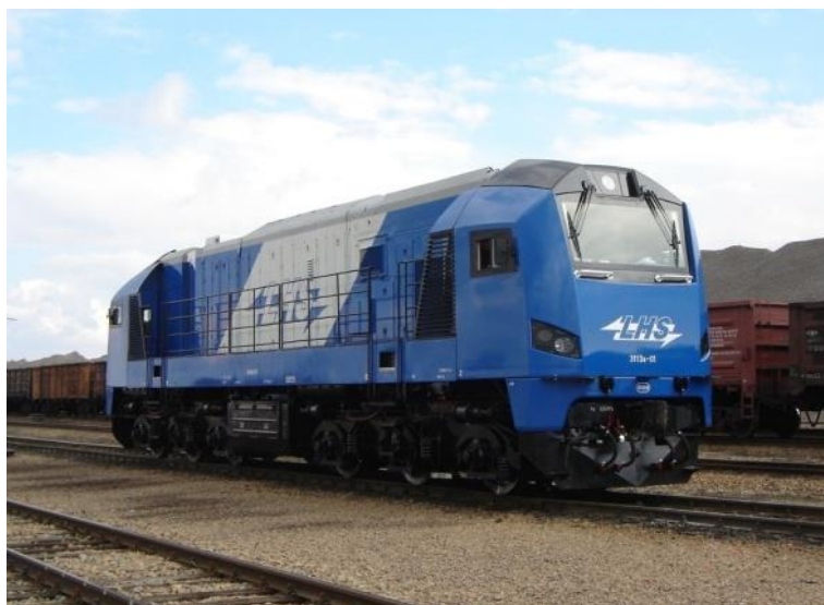
Rys.2. Lokomotywa spalinowa 311 Da po przeprowadzonej modernizacji lokomotywy ST44
